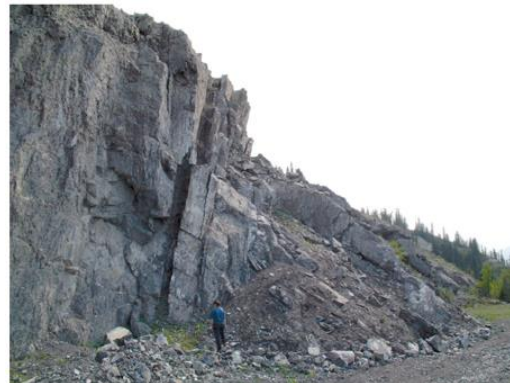
ภาพจำลองลักษณะการถล่มแบบล้มคว่ำ (Topples)
