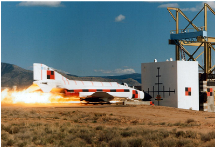
ภาพการทดสอบผนังอาคารคลุมปฏิกรณ์โดยการชนของเครื่องบิน
