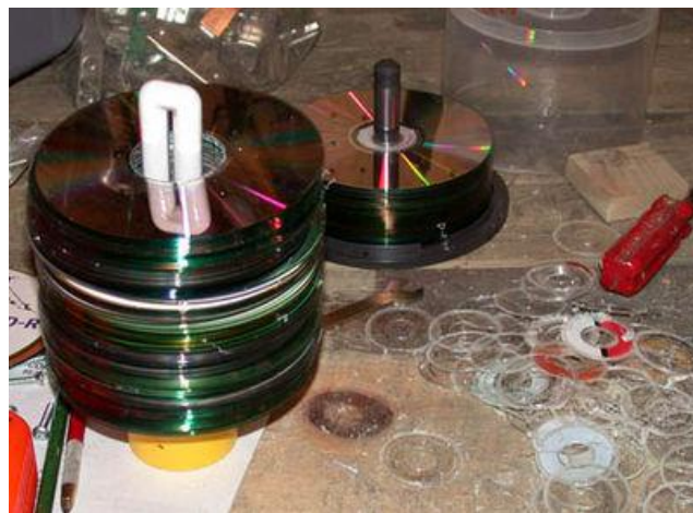
เจาะรูตรงกลางแผ่นซีดี ให้กว้างพอที่จะใส่หลอดไฟได้
