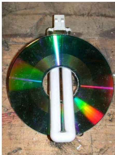
เจาะให้ใส่หลอดไฟได้แบบนี้
