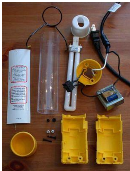
ถอดส่วนประกอบหลอดไฟออก เพื่อจะได้แยกเอาสวิทช์กับหลอดไฟ ไว้สำหรับติดนอกกล่องโคมไฟ
