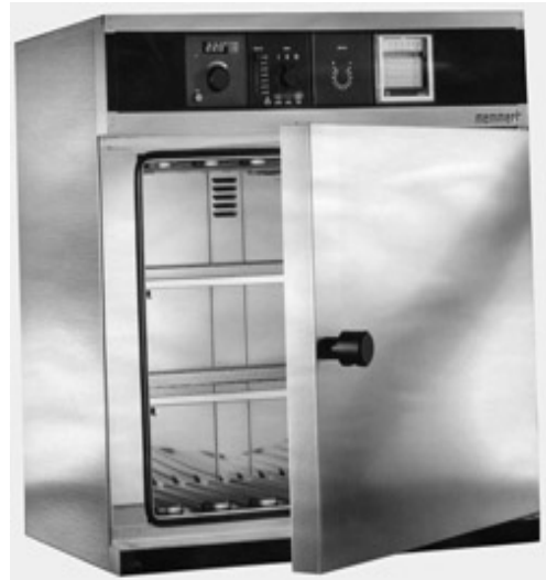
ตู้อบแห้ง (hot air oven) ใช้อบฆ่าเชื้อ เครื่องแก้วและสแตนเลส
