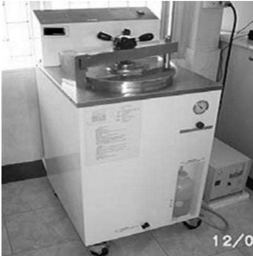
หม้อนึ่งความดัน (autoclave) ใช้ฆ่าเชื้ออาหารและน้ำกลั่น
