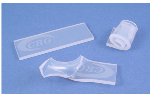
ภาพที่ 4.2 Shape memory polymers คืนรูปได้ แตกหัก-เสียหายซ่อมตัวเอง
