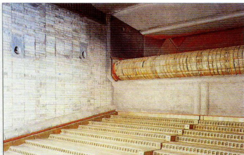
ภาพที่ 6.2 ภาพถ่ายแสดงให้เห็นตะกรับที่อยู่ด้านในของเตาเผามูลฝอย
