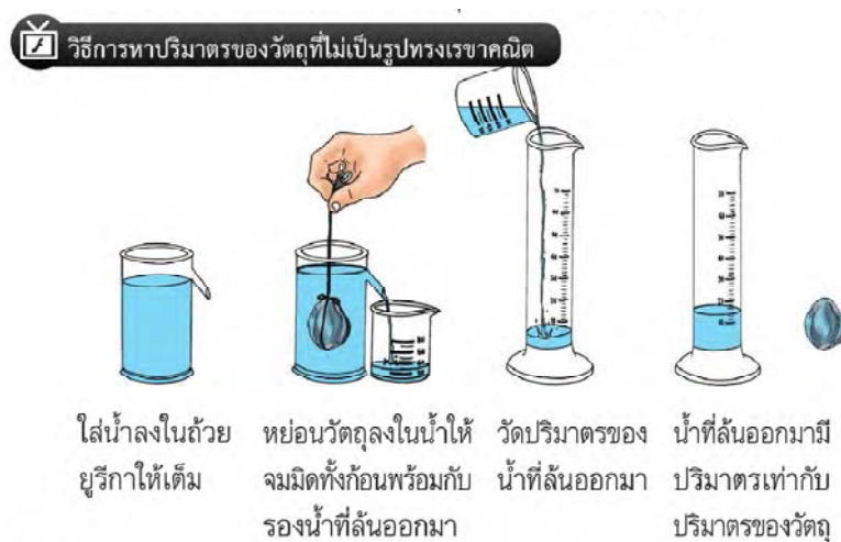
ภาพที่ 2.12 วิธีการหาปริมาตรของวัตถุที่ไม่เป็นทรงเรขาคณิต
